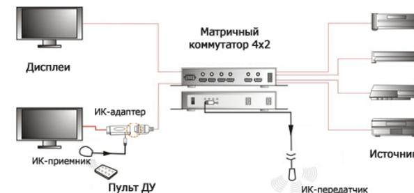
Прибор имеет порты для выносного управления ИК сигналами, передаваемыми в составе протокола HDMI.
